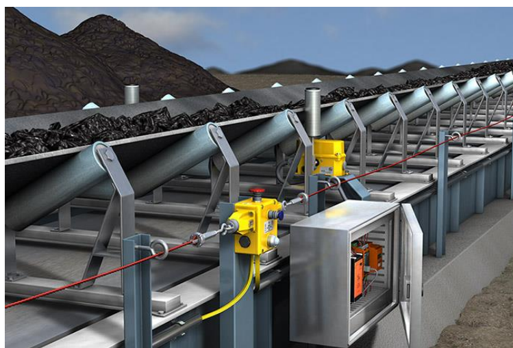
(Esempio arresto di emergenza a cavo continuo)
